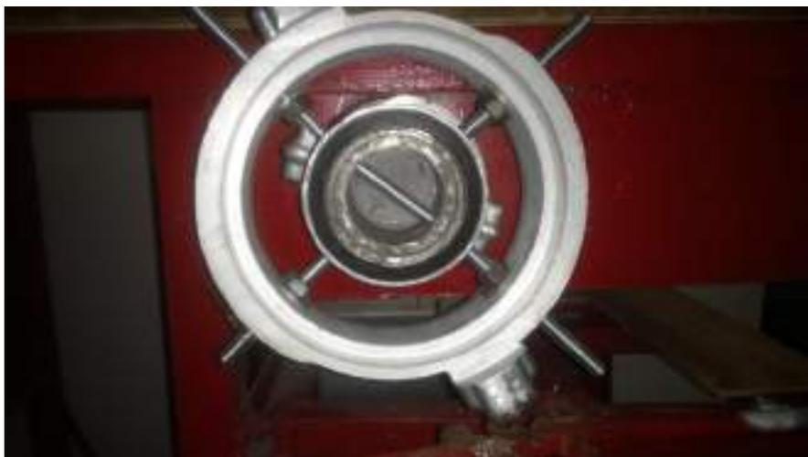
Фото 1 – Переоборудованный станок для навязки пожарных рукавов диаметром 150 мм
