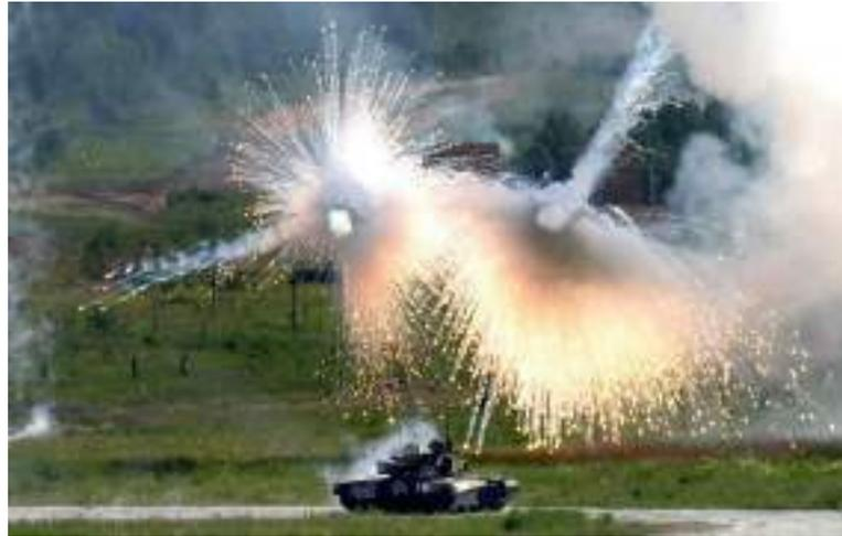
Рисунок 5 – танк Т-80У устанавливает завесу при помощи гранат ЗД17 для противодействия системам наведения средств поражения по команде комплекса оптико-электронного подавления «Штора-1» (фото из открытых источников)
