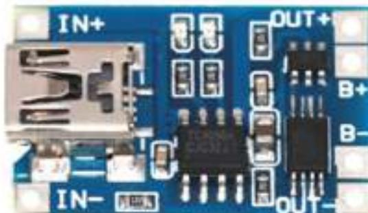
Рисунок 5 – модуль зарядного устройства литиевой батареи
