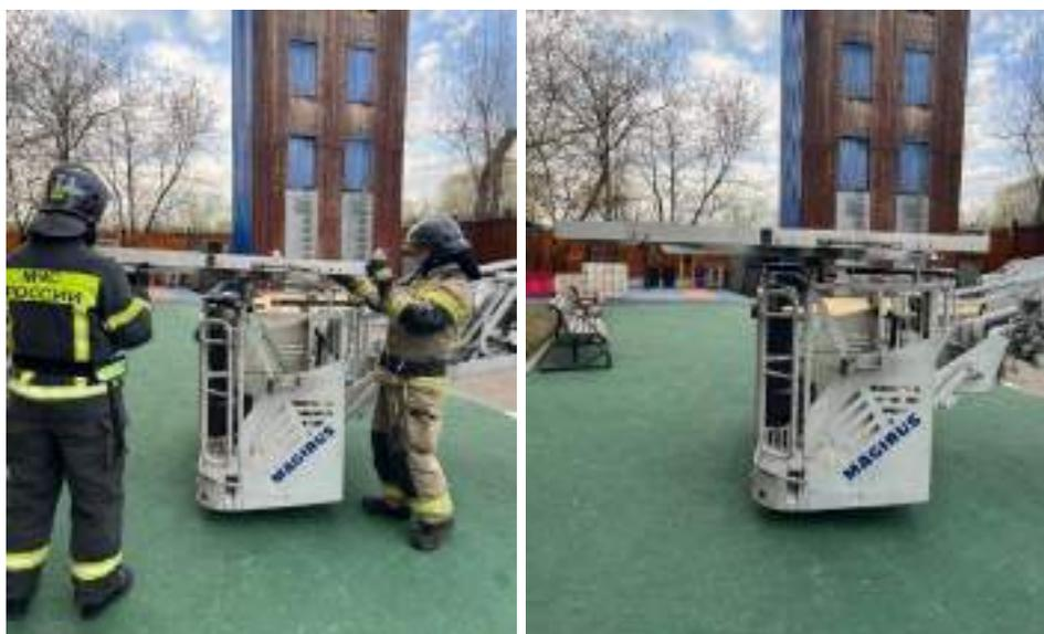
Осуществляем сборку установки. С помощью крепежных ремней соединяем между собой вентиляционное устройство, воздухопроводный переходник (адаптер) и пенный генератор. Запуск вентиляционного устройства производим на земле.
