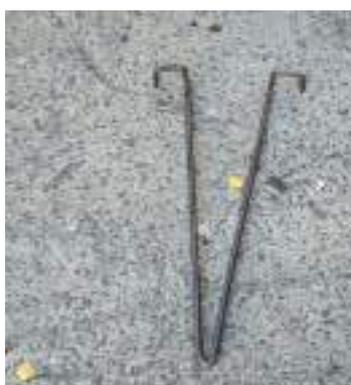
Крюк для испытания лестниц штурмовой и палки
