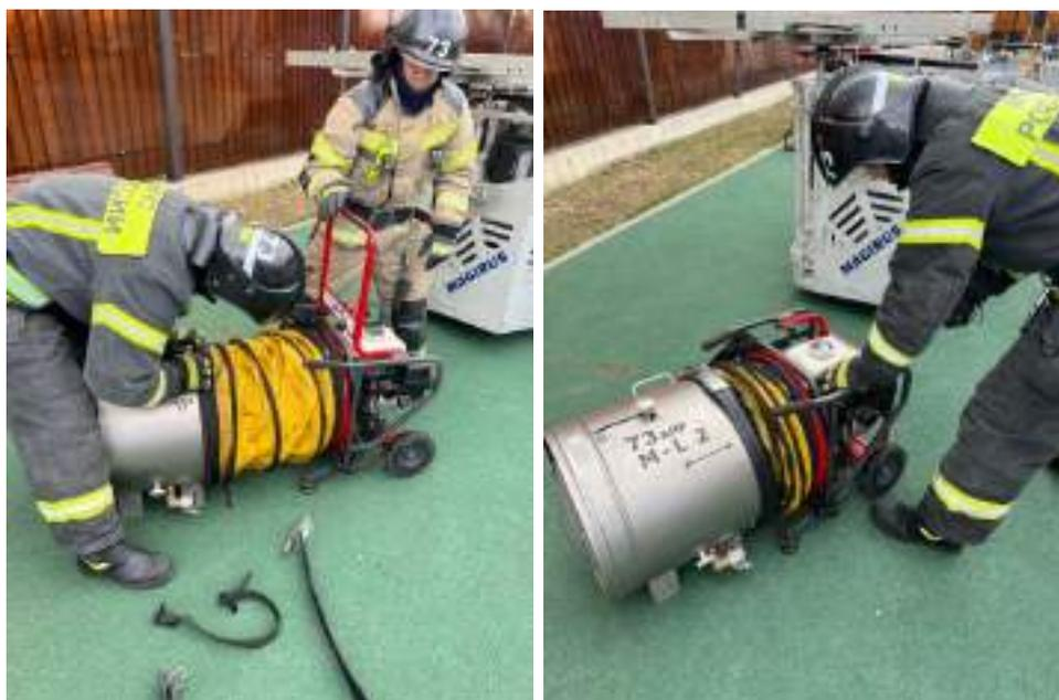
Размещаем систему генерации пены на платформе автолестницы с использованием модуля крепления, входящего в её комплект. Далее фиксируем все составляющие крепёжными ремнями. Подключить систему к автоцистерне, согласно схемам безопасной подачи пены.
