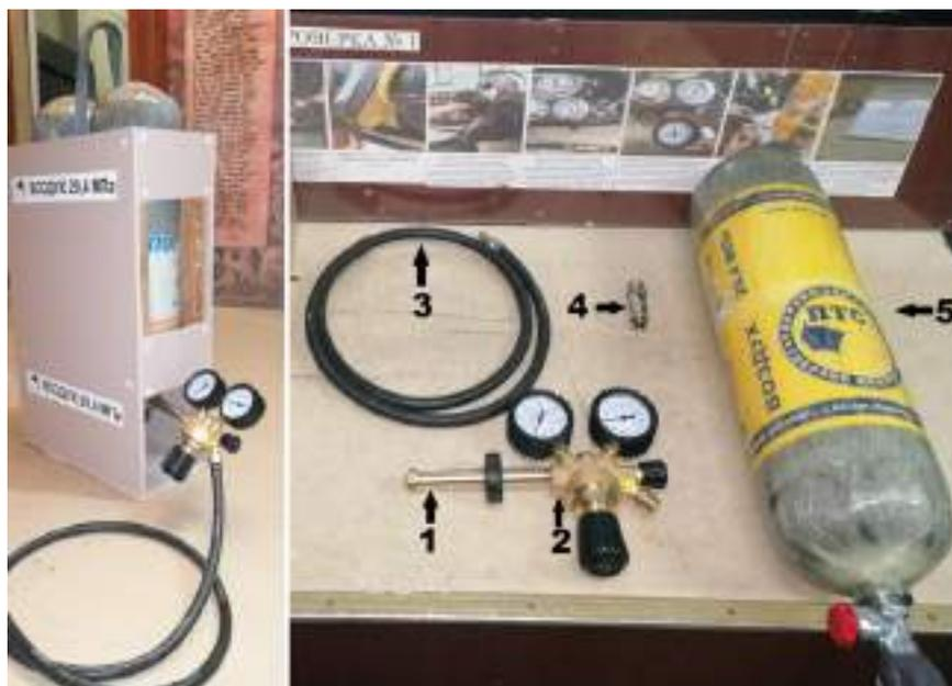
Рисунок 3 – Элементная база мобильной станции заправки модулей порошкового и водяного пожаротушения: 1 – соединительный штуцер (ввинчивается в регулятор); 2 – регулятор WR 500; 3 – рукав высокого давления (РВД 300 атм.) с установленными фитингами; 4 – адаптер с быстроразъемным соединением; 5 – баллон со сжатым воздухом
