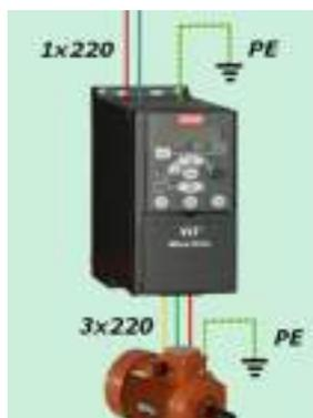
Рисунок 2 – Схема подключения частотного преобразователя
