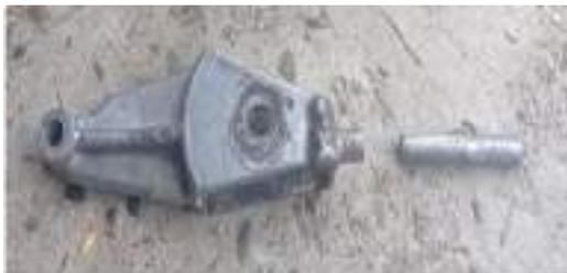
неисправный механизм трехколенной лестницы, выполненный из алюминия
