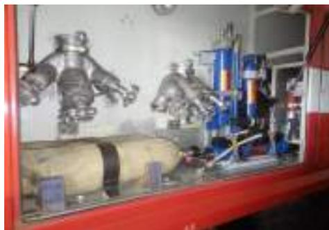
Общий вид крепления ГАСИ «Медведь» в отсеке пожарного автомобиля АЦ-2,5-40 (5313)»
