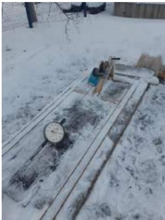
Рисунок 2 – Закрепление динамометра ДПУ-0,5-2 на стенде
