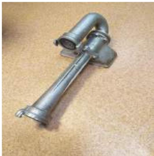
Рисунок 1 – Кавитатор теплогенерирующий (вид сверху)
