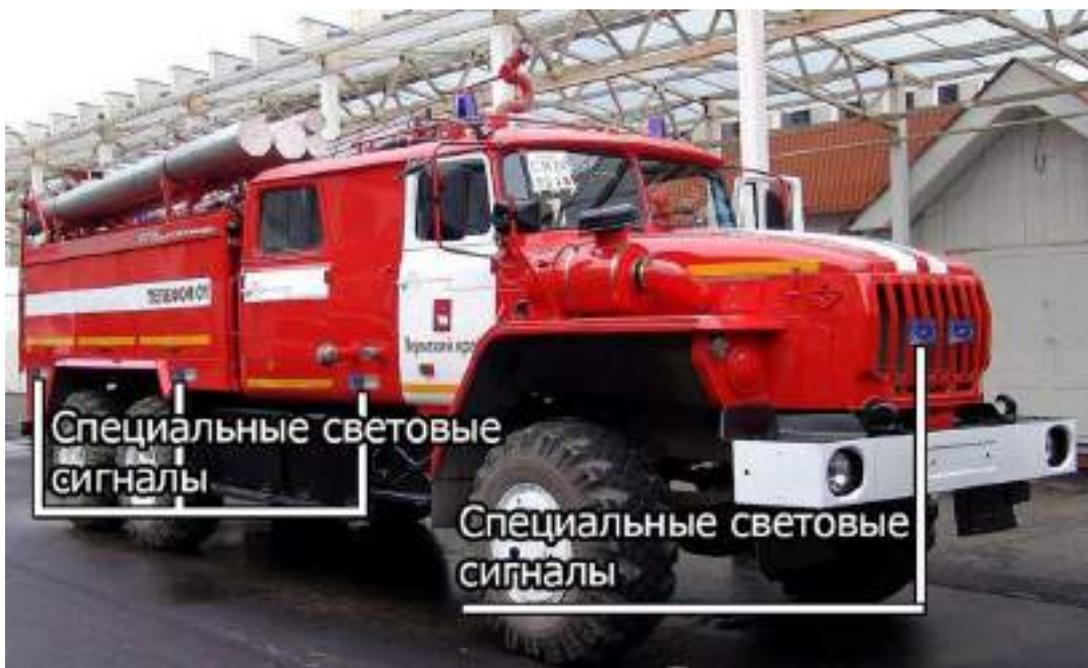
Рисунок 6 – Макетное размещение проблесковых маячков на примере АЦ-6,0-40 (УРАЛ-5557)
