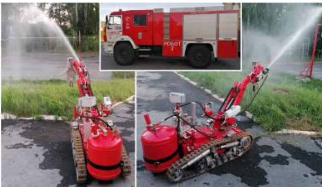
Рисунок 1 – Мобильный роботизированный комплекс разведки и пожаротушения – МРК-РП при тренировке подачи тонкораспыленной воды и автомобиль технической поддержки АБР-Робот (вверху)
