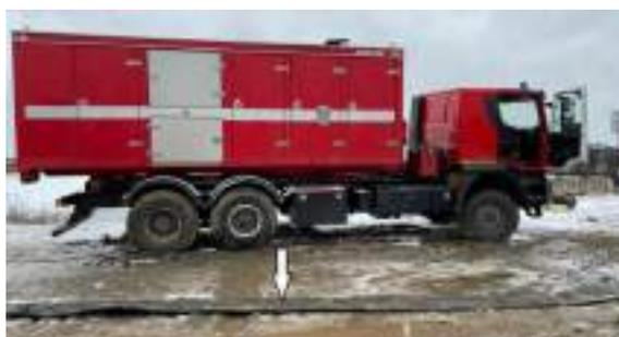
Рисунок 2 – Общий вид комплекса в транспортном положении (стрелкой показан напорный рукав диаметром 300 мм)
