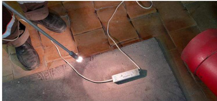
Рисунок 3 – Применение штанги со светодиодной насадкой для осмотра
