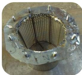
Рисунок 12 – Пластина для крепления малой и большой сетки
