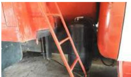
*Обратный клапан (4)* – это узел в системе, который служит для сохранения максимального разряжения в системе.
