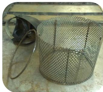
Рисунок 8 – Закругление краев сеток вокруг обода жесткости
