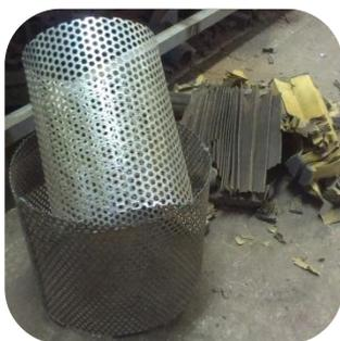
Рисунок 4 – Набор сеток для изготовления насадки
