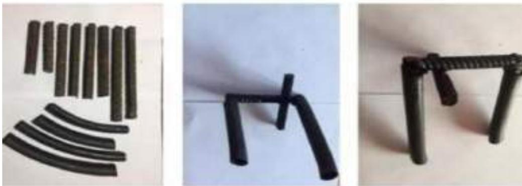
Изготовление устройства проводится путем сварки деталей, состоящих из восьми частей, затем детали шлифуются, надевается амортизирующий шланг.
