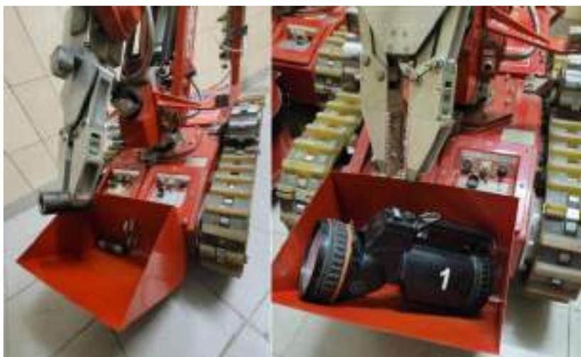
Рисунок 2 – Крепление контейнера осуществляется стандартными (из комплектации) буксирными проушинами
