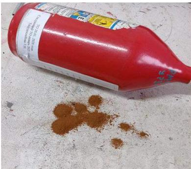
Рисунок 2 – Результат очистки внутренней поверхности огнетушителя
