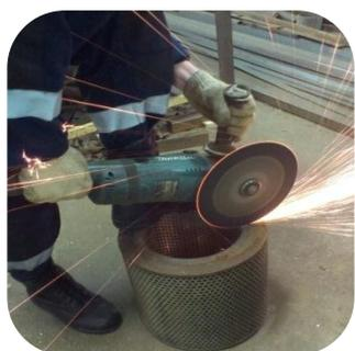
Рисунок 2 – резка фильтра
