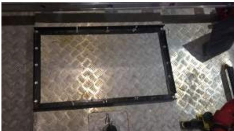
Крепление для мотопомпы размещено на автоцистерне
