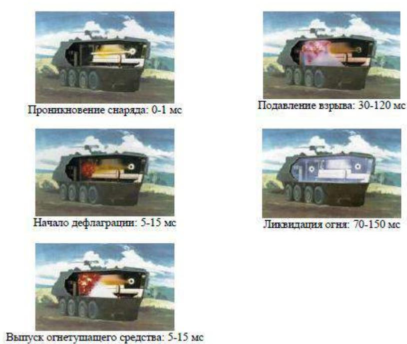
Рисунок 6 – Схема функционирования оборудования для подавления возгорания фирмы Kidde-Deugra (компьютерная модель)
