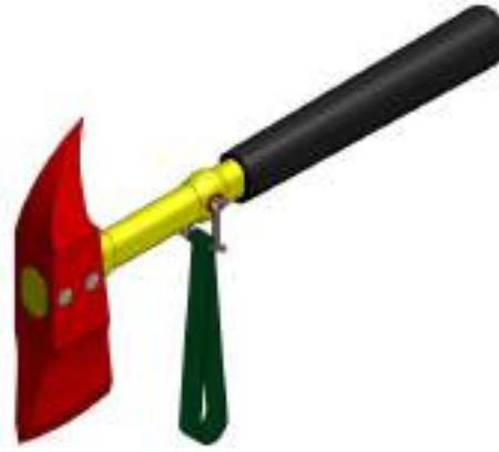
Рисунок 3.14 – Топор с лямкой (предложенная модернизация)
