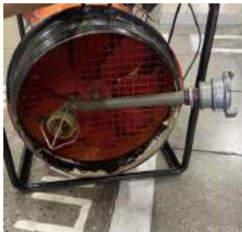
Рисунок 1 – Крепление пожарного ствола-распылителя к переносному электровентильатору
