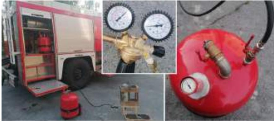
Рисунок 4 – Процесс проведения ТО модуля МВП-50ПС по заправке давлением в «полевых условиях» с помощью мобильной станции
