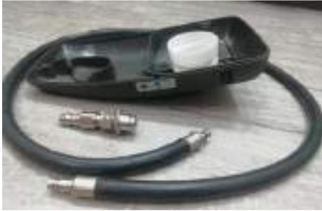
крышка фильтрующего элемента бензореза с внутренней стороны
