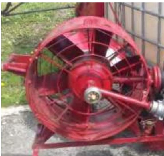
Рисунок 4 – Крепление пожарного ствола-распылителя к переносному электроventильатору
