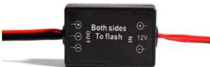
Рисунок 9 – Готовый стробоскопный модуль
