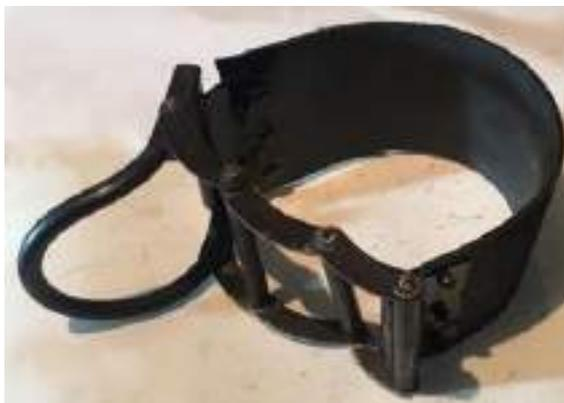
Рисунок 5 – Опытный образец технического решения, предназначенный для работы с пожарными рукавами диаметром 300 мм НРК «ШКВАЛ»
