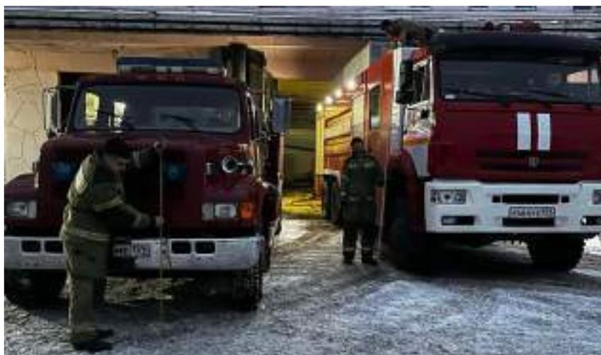
Рисунок 3 – Измерение высоты размещения проблесковых маячков на примере АЦ-10-150(КАМАЗ-65225)018МИ (справа) и АЦ-3,6-60 (E-ONE-INTERNATIONAL 4900)
