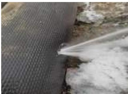
Рисунок 3 – Порыв на напорном рукаве 300 мм при тушении пожара
