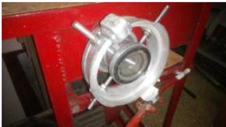
Фото 2 – Переоборудованный станок для навязки пожарных рукавов диаметром 150 мм
