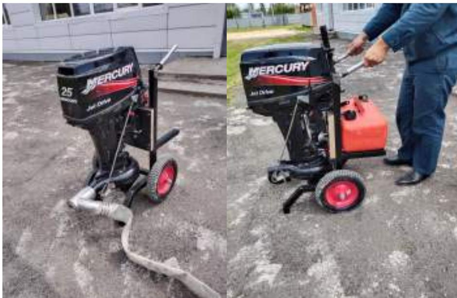
Рисунок 2 – Транспортная тележка с установленным подвесным лодочным мотором «Mercury 25Jet»
