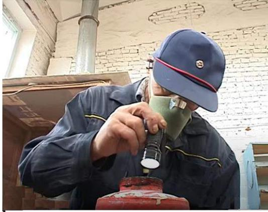
Рисунок 1 – Осмотр внутренней полости огнетушителя при освидетельствовании
