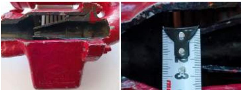
Рисунок 3 – Элементная база построения кавитатора (показана на учебном макете гидроэлеватора Г-600А)
