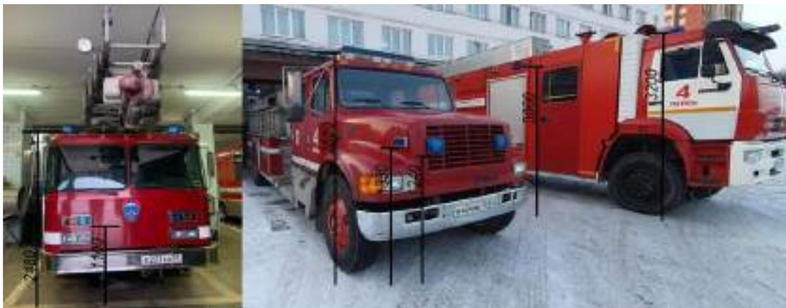
Рисунок 4 – Расстояние от поверхности земли (в мм) и расположение проблесковых маячков на пожарных автомобилях
