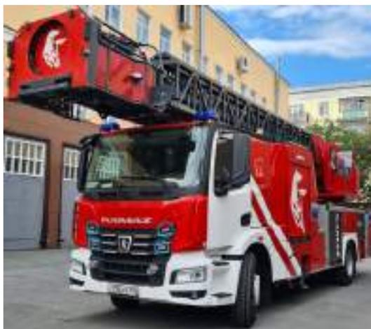
Рисунок 5 – Расположение проблесковых маячков в передней части и боковых поверхностях (обведены синими кругами) на примере АЛ-42 (КАМАЗ 63934)
