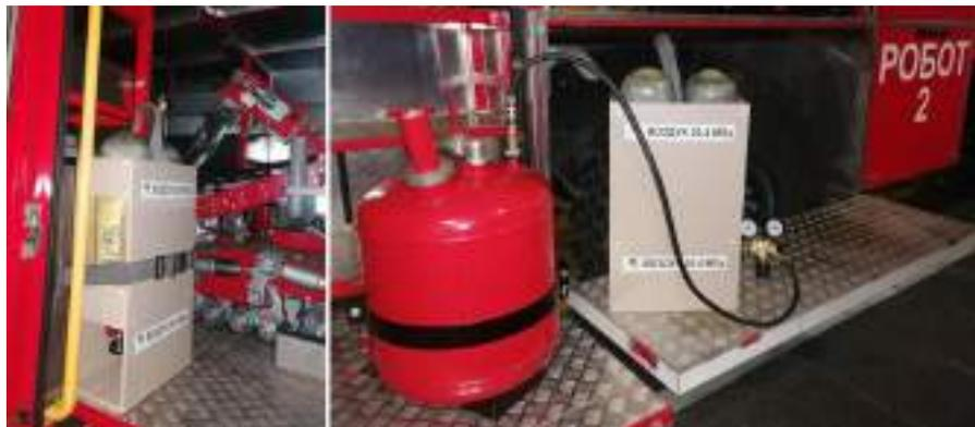
Рисунок 5 – Размещение мобильной станции заправки модулей порошкового и водяного пожаротушения комплекса МРК-РП на АРБ-Робот (слева) и процесс заправки в гараже боевых машин с использованием откидных платформ автомобиля
