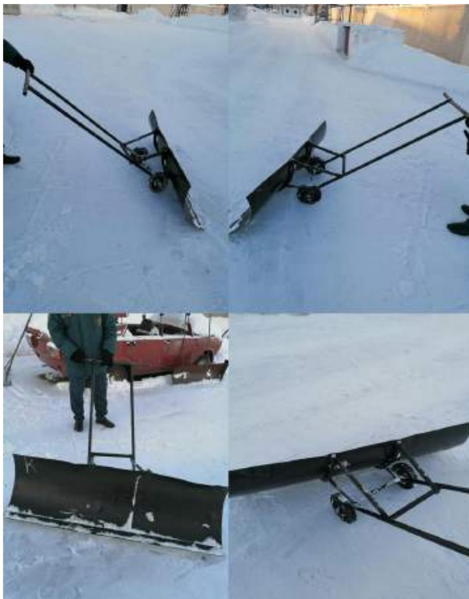
Рисунок 1 – Ручной снегоочиститель с колесами
