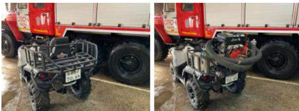
На данное место можно установить: пожарную мотопомпу «Дева», рукава диаметром 51 мм. в количестве 4 шт., ствол «Б», напорно-всасывающий рукав 77 мм., сетку всасывающую СВ-77 и переход 66 × 51.
