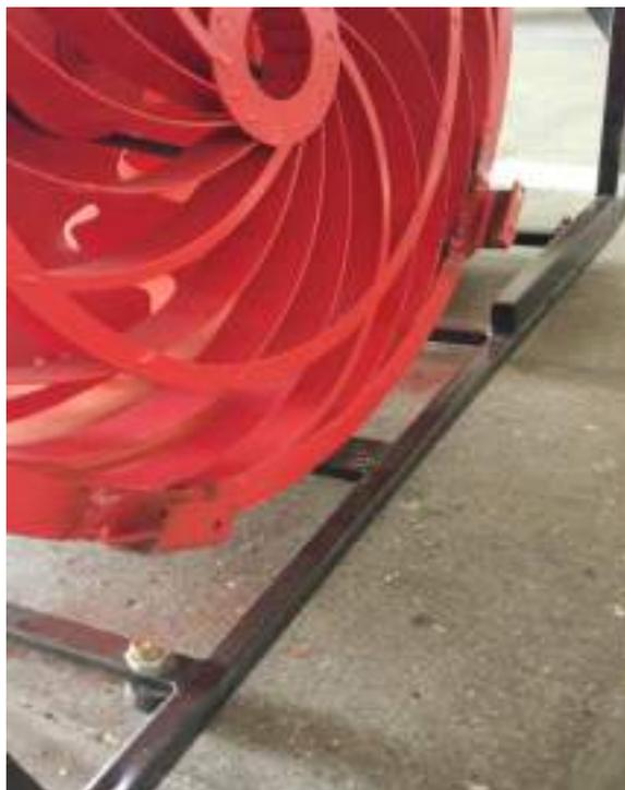
Рисунок 3 – Металлические уголки, приваренные к корпусу электроventильатора
