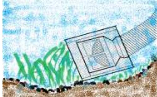
Рисунок 16 – Забор воды с использованием насадки
