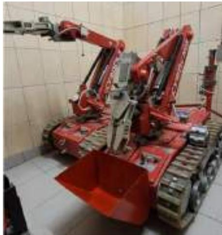
Рисунок 1 – Установленный контейнер на МРК-РП, слева вариант в «заводском исполнении»
