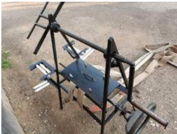
Модернизация станка для намотки рукавов в станок для перекатки рукавов на другое ребро.
