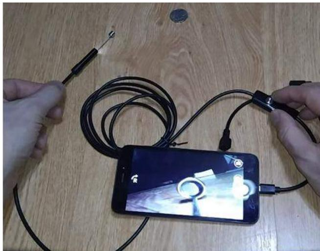
Рисунок 4 – Эндоскоп на основе мобильного телефона
