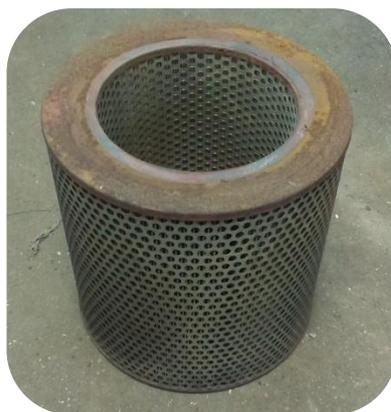
Рисунок 1 – Воздушный фильтр дизельного двигателя (МАЗ, КАМАЗ, УРАЛ)
