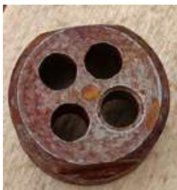
Рисунок 4 – Кавитационный элемент, устанавливаемый в сопле
