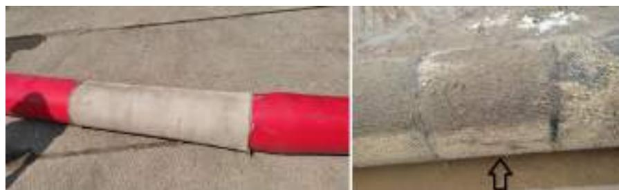
Рисунок 4 – Варианты бандажей напорного рукава диаметром 300 мм: на правом снимке стрелкой показан использованный бандаж при заделывании свища в работах по тушению пожаров в микрорайоне «Солнечный»
