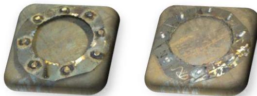
Рисунок 10 и рисунок 11 – Стальная пластина с вставленными в неё болтами и приваренными шляпками
