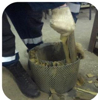
Рисунок 3 – разборка фильтра
