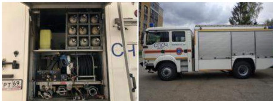
Для вывоза своего запаса рукавов и самостоятельной работы на небольшом расстоянии силами личного состава было оборудовано место для хранения 16 шт. рукавов диаметром 150 мм в отсеке ПНС-110.
