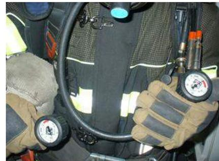
Подключение газодымозащитника к резервному аппарату, не выключаясь от основного
