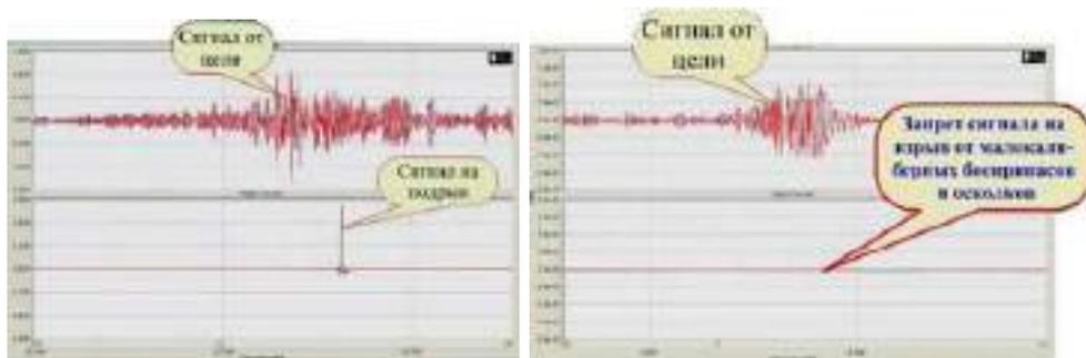
Рисунок 2 – диаграмма обнаружения КАЗ «Заслон» (Украина) РПГ и 30 мм боеприпаса. В случае перехвата низкоскоростных (70...100 м/с.) противотанковых средств создается задержка срабатывания БЧ. В случае обнаружения средств, не представляющих угрозы танку (30 мм граната и пр.) сигнал на подрыв БЧ не подается
