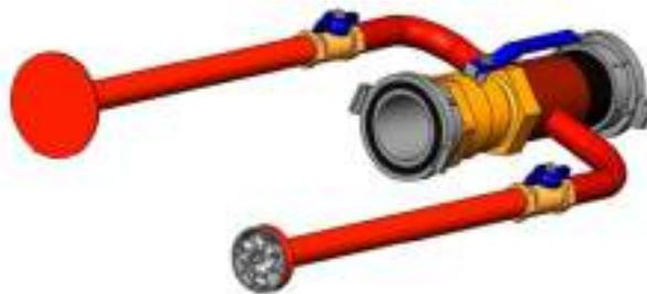
Рисунок 3 – Трехмерная модель пожарного оборудования для повышения функциональных возможностей ручных пожарных стволов
