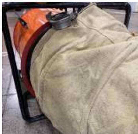
Рисунок 2 – Крепление пожарного ствола-распылителя и напорного рукава к переносному электровентильатору
