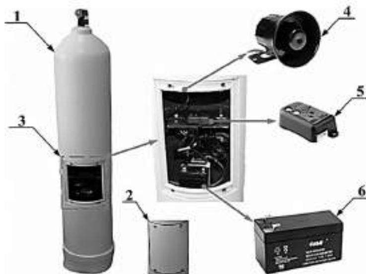
Рисунок 2 – Устройство тренажера «Ацетиленовый баллон»
