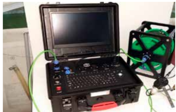
Рис. 3.40. Водолазный телевизионный комплекс «Глаз Посейдона»
