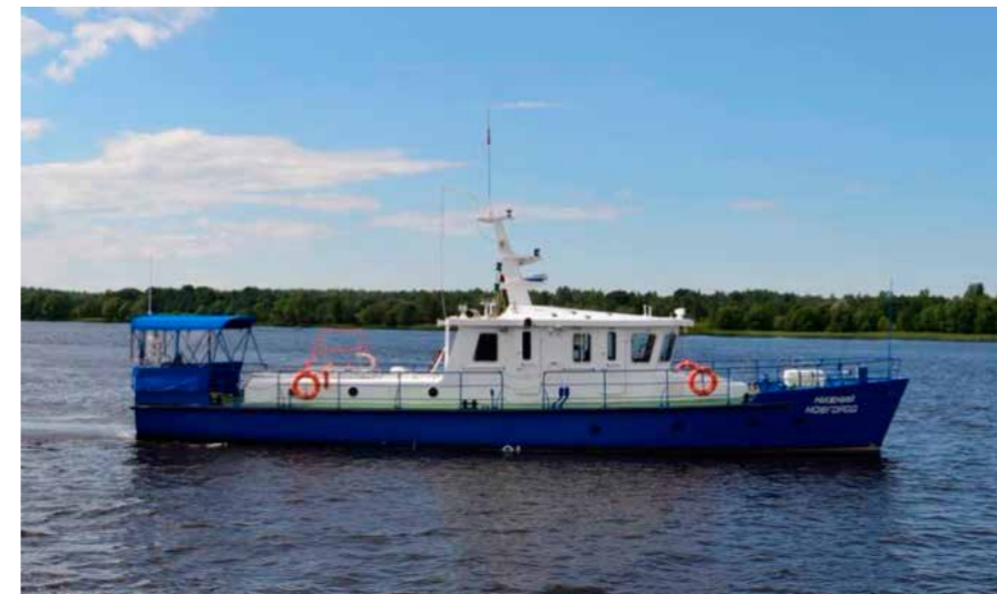
Рис. 3.44. Водолазное судно с барокамерой Ярославец – МВП проекта 02220
