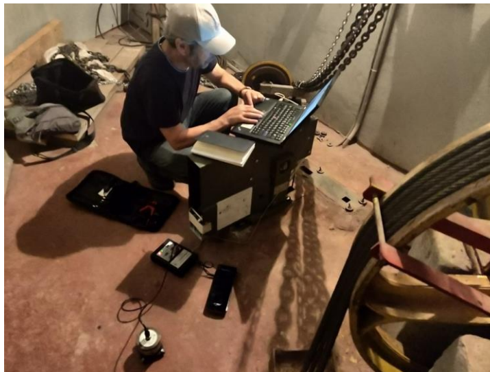
Фото 2.5. Пункт сбора динамических данных на отм. +144,50 м в железобетонной части башни
