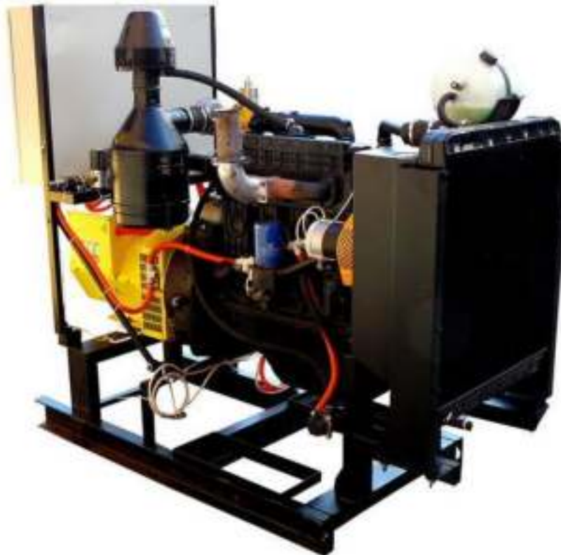
Рисунок 1 – Пиролизный генератор (газоэлектростанция) 30 кВт на ММЗ Д 246
