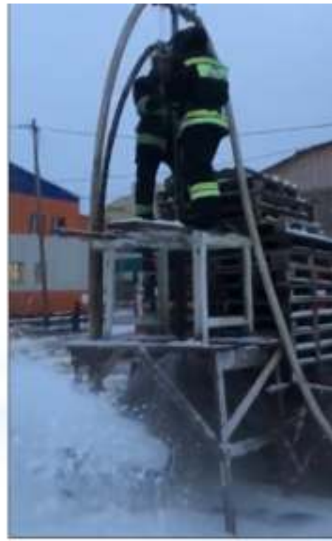
Рисунок 2. Установка устройства на входном люке коллектора и аэробация с подачей огнетушащего вещества на полигоне
