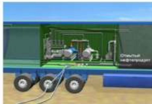
Рисунок 1 – Оборудование для откачки, очистки различных жидкостей (а – пожарный насос расположенный внутри кабины пожарного автомобиля для подачи и забора огнетушащего вещества; б – общий вид пожарного насоса; в – насосная установка с резервуаром в котором содержится раствор технического моющего средства для размыва, отмыва нефтепродукта; г – насосная установка для емкость для отмытого нефтепродукта)
