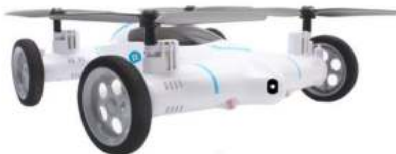
Рисунок 1 – Двухсредное робототехническое средство сверхлегкого класса для проведения разведки и мониторинга зоны ЧС
