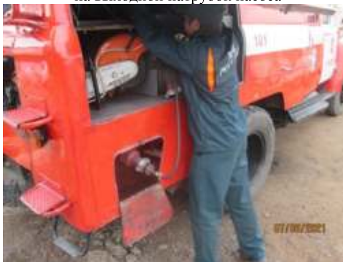
Фото № 2 Подключаем переходник на выходной патрубке насоса
