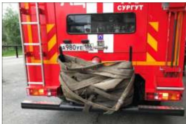
Фото применения кронштейнов после пожара (полугайки должны быть соединены друг с другом)
