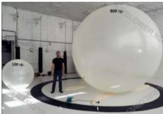
Рисунок 2 – Метеозонд диаметром 4,1 м и массой 800 г
