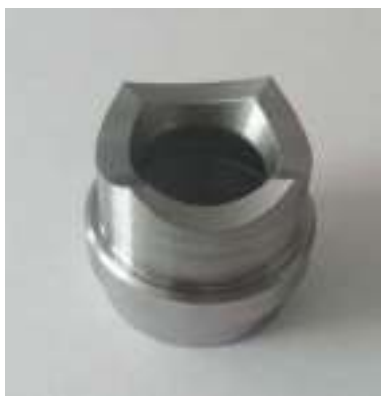
Рис. 1 Коронка стеклобойная (вариант) а-общий вид, б-установленная на ствол
