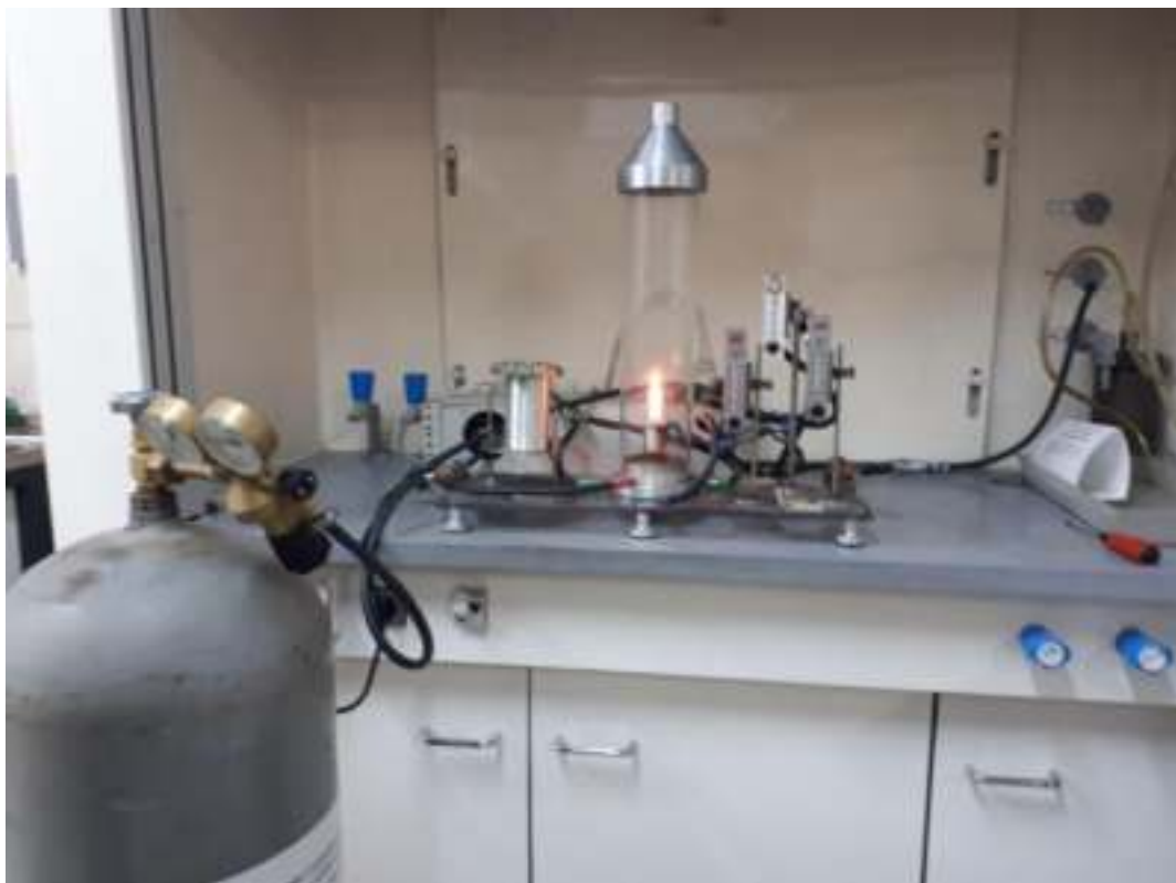
Рисунок 1 – Установка для определения минимальной огнетушащей концентрации хладонов
