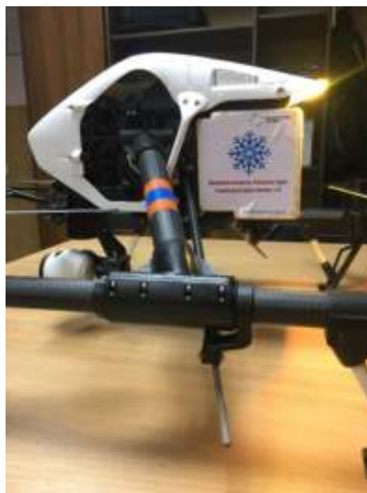
Рис. 3 Закрепленное удерживающее устройство на посадочной штанге беспилотного воздушного судна.
