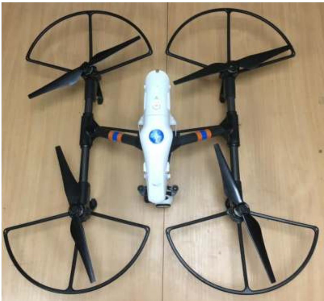
Рис. 1 Общий вид сверху беспилотного воздушного судна DJI Inspire 1V2 с закрепленными удерживающими устройствами
