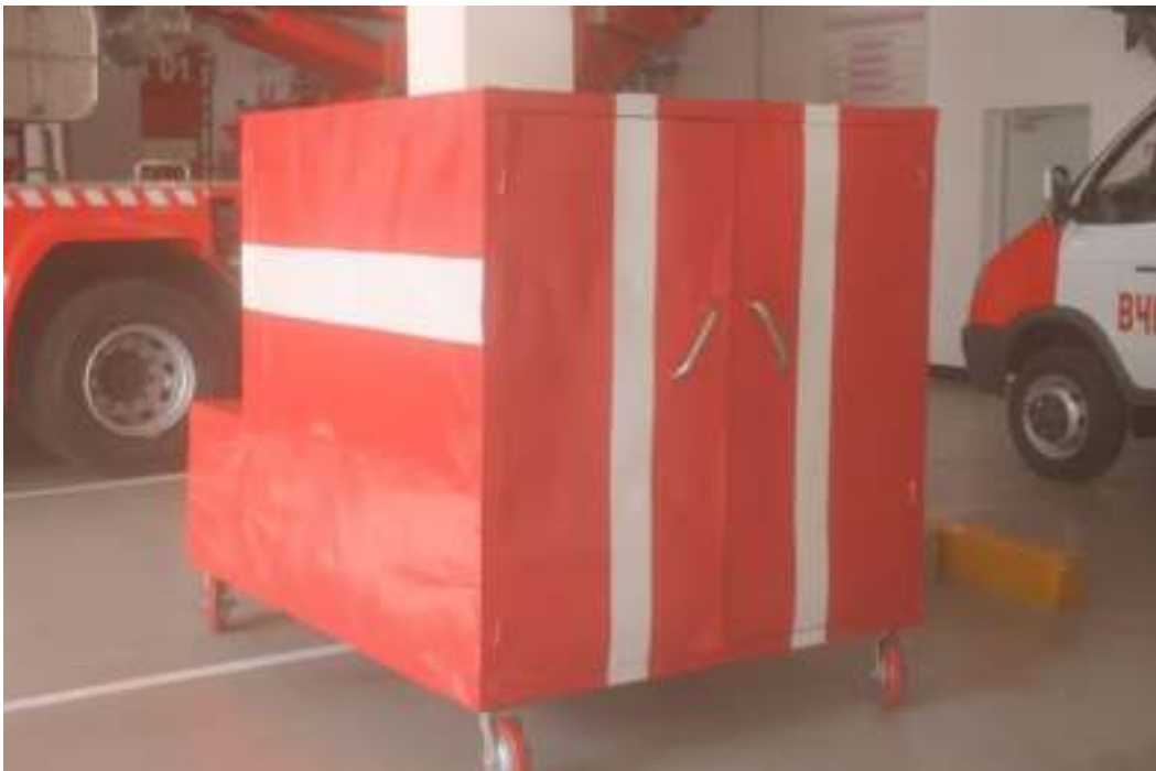
Рисунок 2- общий вид сушилки для пожарных рукавов и БОП
