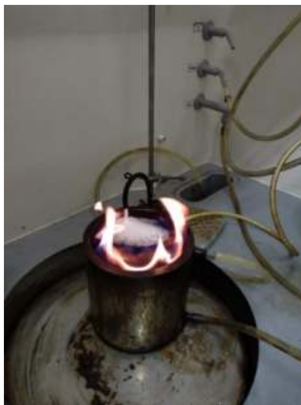
Рисунок 2 – Установка подачи пены, перемешанной с хладоном для тушения нефтепродукта в лабораторных условиях
