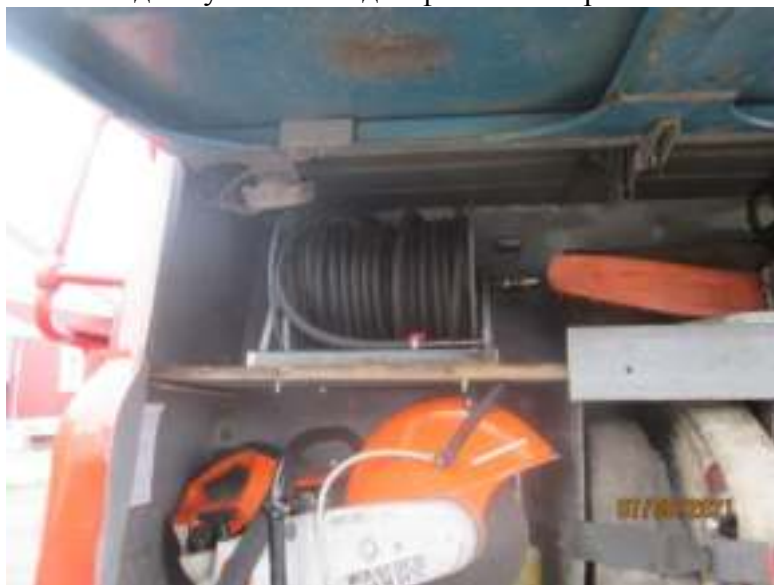
Фото № 1 Приспособление «Катушка со шлангом с насадкой для тушения ландшафтных пожаров».
