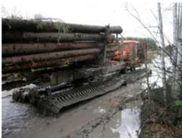
Рисунок 1.6 – Транспортно-технологическая машина повышенной проходимости с полуприцепом на шасси завода ООО «ЕВСМ «Континет» при транспортировании пачки деревьев в полностью нагруженном положении в сложных природно-климатических условиях.
