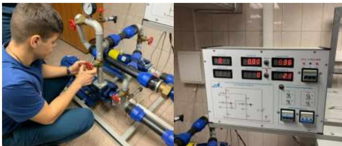
а б Рисунок 1 – Лабораторный стенд по изучению рабочих характеристик пожарных насосов:
