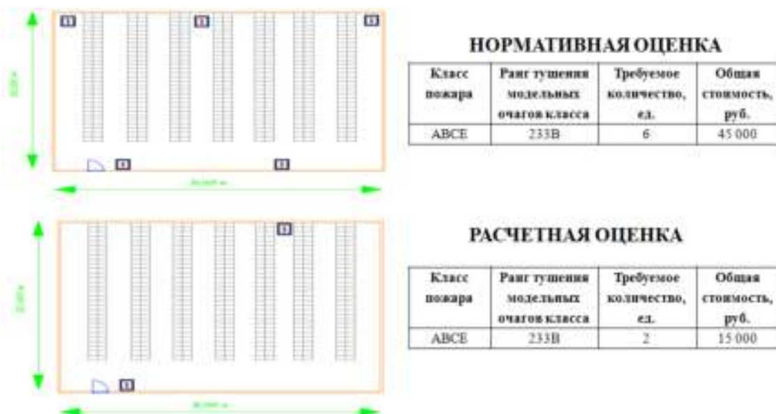
Рисунок 1 – Расчетная оценка нормативного и расчетного количества передвижных огнетушителей в помещении складского здания
