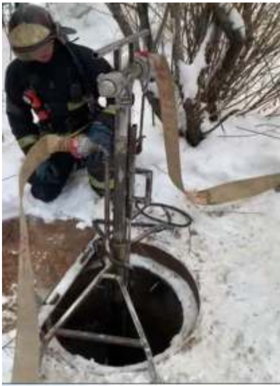
Рисунок 2. Установка устройства на входном люке коллектора и аэробация с подачей огнетушащего вещества на полигоне
