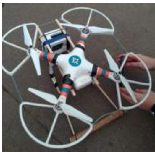
Рисунок 3 – Внешний вид воздушного комплекса: БПЛА, снабженный газоанализатором
