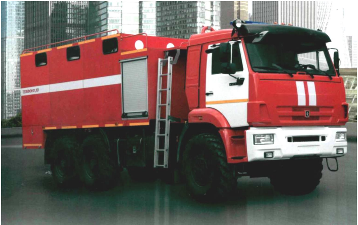
Рисунок 65 – Пожарный рукавный автомобиль АР-2 на шасси КамАЗ 43118
