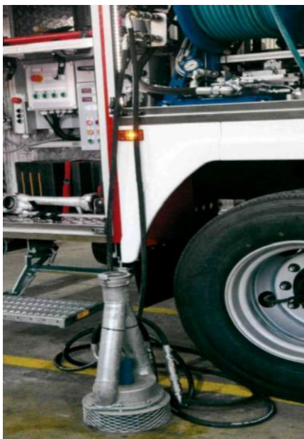
Рисунок 71 – Гидравлической системой привода мощности оборудования АПС 3,0-50
