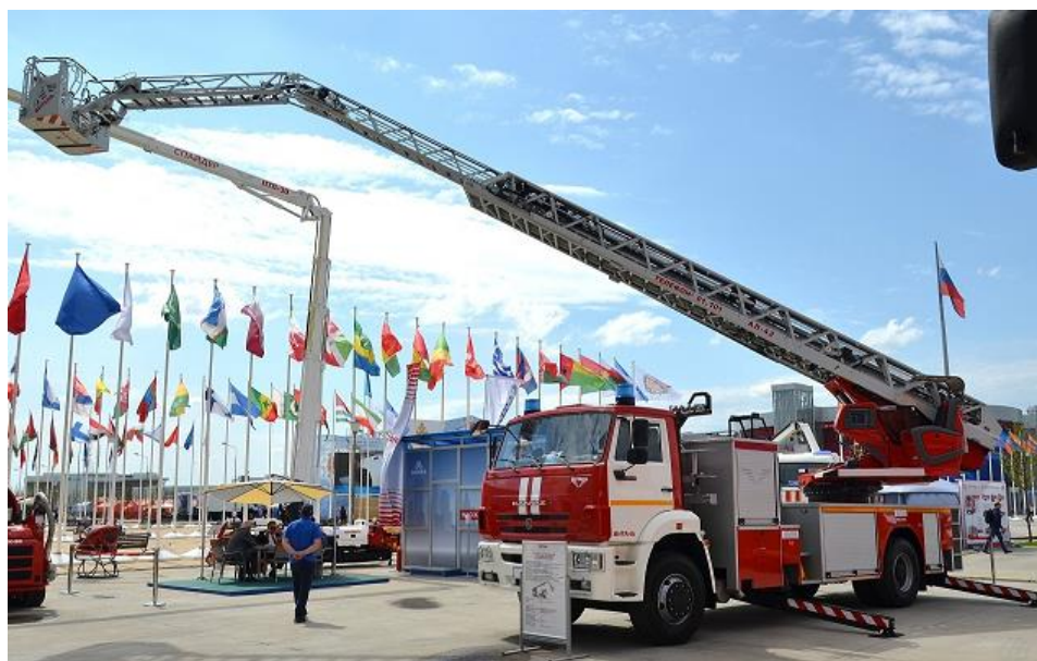
Рисунок 76 – Пожарная автолестница АЛ-42(53605)
