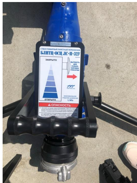
Рисунок 129 – Переносной пожарный лафетный ствол «Блиц»
