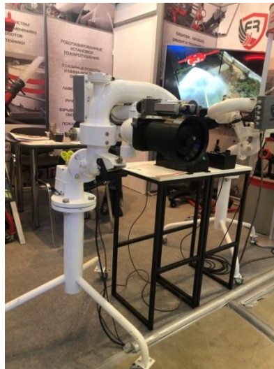
Рисунок 132 – Лафетные стволы производства ООО «Инженерный центр пожарной робототехники «ЭФЭР»
