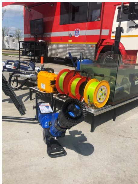
Рисунок 129 – Переносной пожарный лафетный ствол «Блиц»
