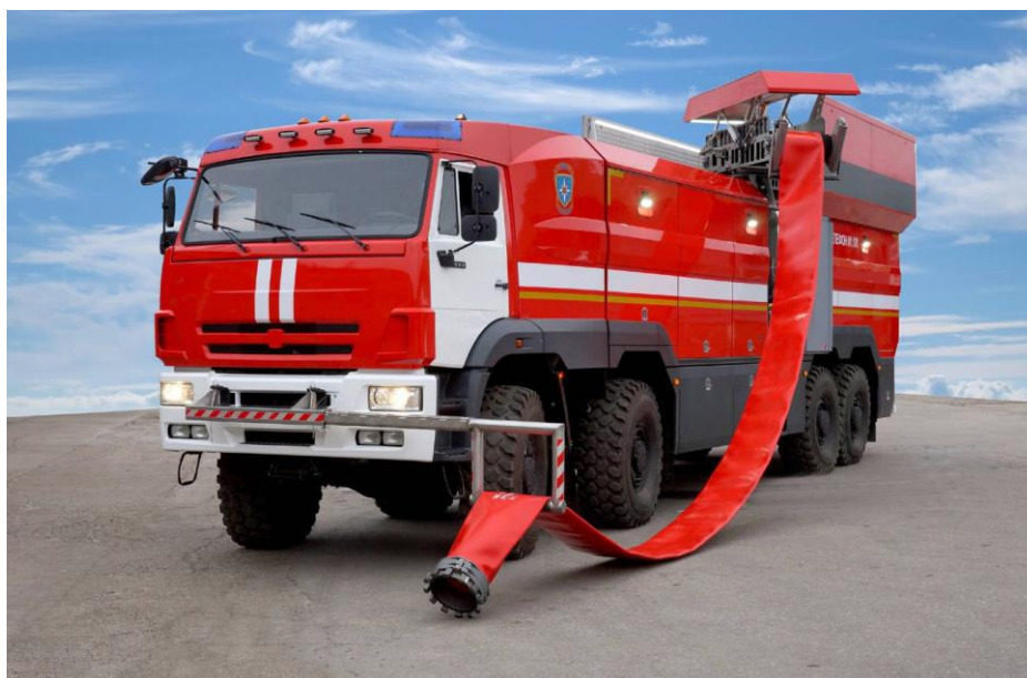
Рисунок 60 – Мобильный насосно-рукавный комплекс НРК-А на шасси КАМАЗ- 6560 (8х8)
