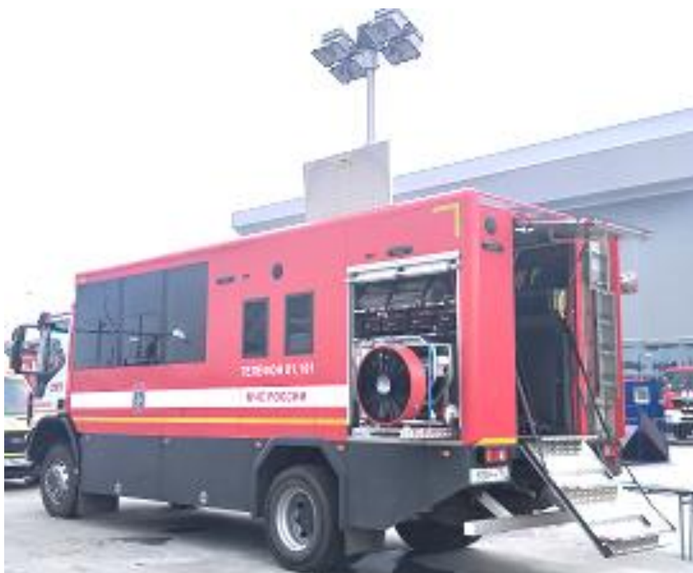
Рисунок 58 – Пожарный автомобиль газодымозащитной службы многоцелевой АГМ 35-50-400 на шасси IVECO-AMT (4x4)
