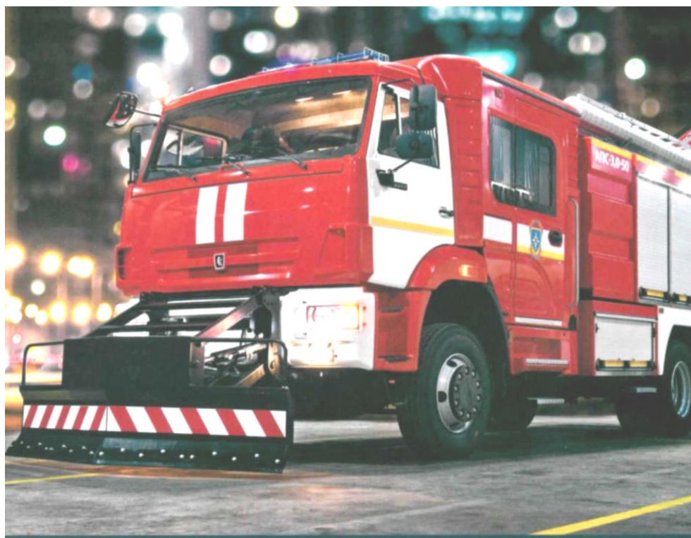
Рисунок 68 – Автомобиль пожарно-спасательный АПС 3,0-50 на шасси КамАЗ-43265 (4x4.2)
