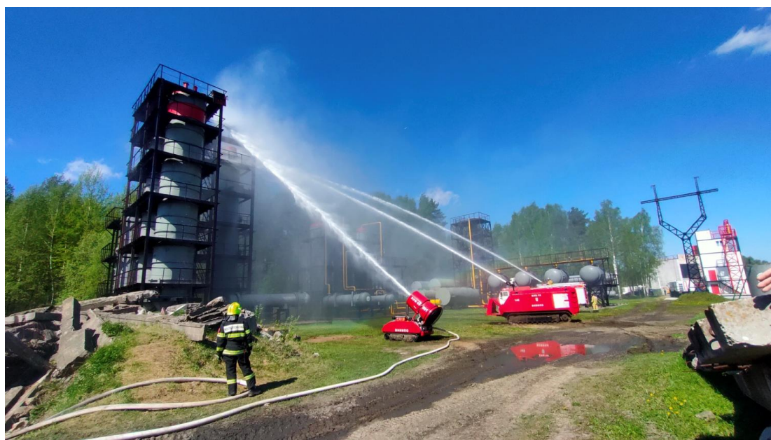
Рисунок 31 – Тушение и охлаждение резервуаров с применением РТК
