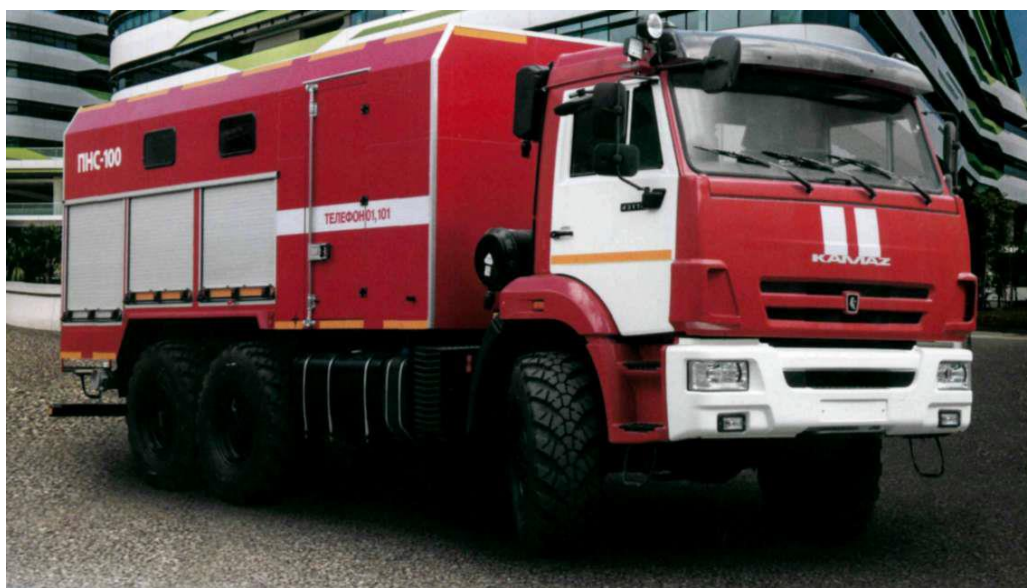
Рисунок 64 – Пожарная насосная станция ПНС-100 на шасси КАМАЗ 43118 (6х6)
