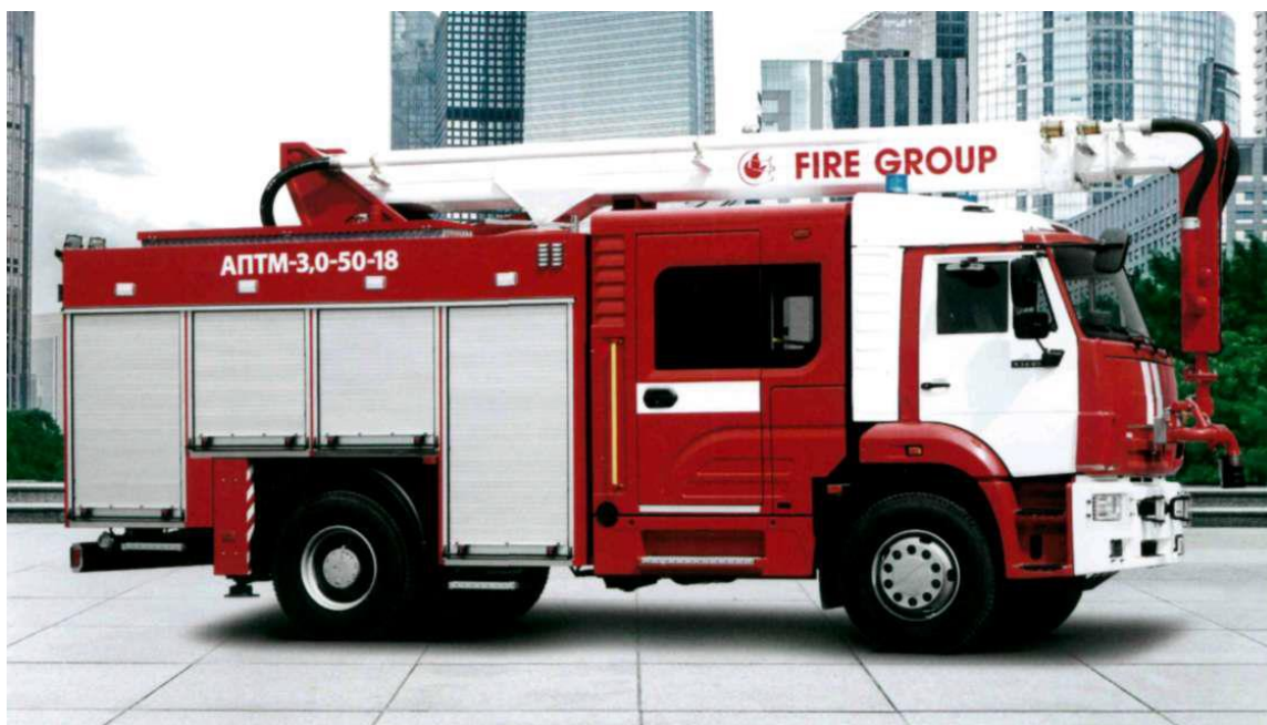
Рисунок 66 – Пожарный автомобиль пенного тушения с мачтой АПТМ 3,0-50-18 на шасси КамАЗ 53605 (4х2)
