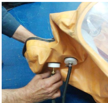
Рис. 11 Установка адаптера и заглушки
