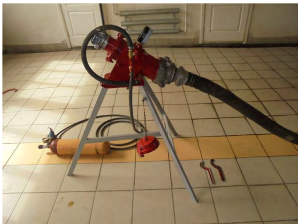
Испытание напорно-всасывающего рукава Ø 77 мм
