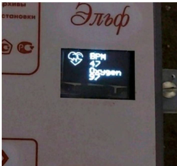
Показания экрана при работе прибора строка Оxygen показывает процент кислорода в крови
