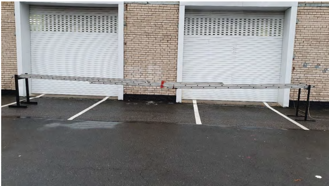
Рисунок 4. ВПЛ в разложенном состоянии готова к испытанию ступеней на скручивание.
