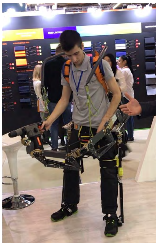
Рисунок 4 – Фиксация тяжелого инструмента на весу с помощью экзоскелета
