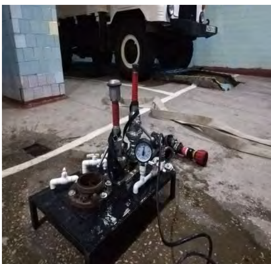
проведение испытаний пожарных колонок, стволов, рукавной арматуры (слева – от ручного опрессовщика, справа – от пожарного насоса)
