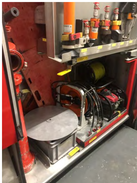
Рисунок 5 – Один из вариантов размещения предлагаемого технического решения на примере АЦ-3,2-40/4 (КАМАЗ 43253)
