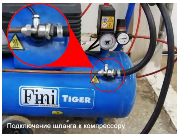
Узел подключения воздушной системы пожарного автомобиля к компрессору
