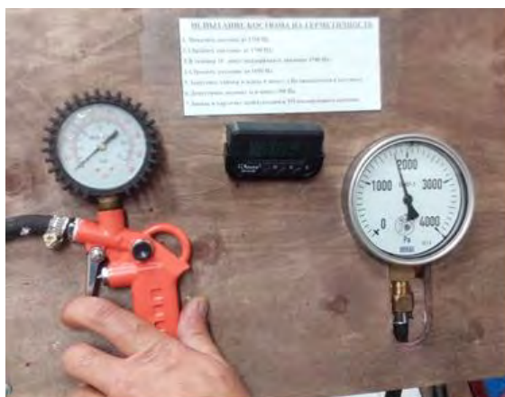
Рис. 12 Закачка воздуха в изолирующий костюм через клапан на адаптере
