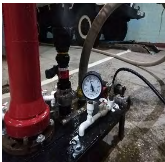
проведение испытаний пожарных колонок, стволов, рукавной арматуры (слева – от ручного опрессовщика, справа – от пожарного насоса)
