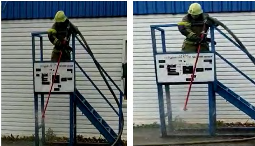
Рисунок № 5 - Процесс испытания ствола
