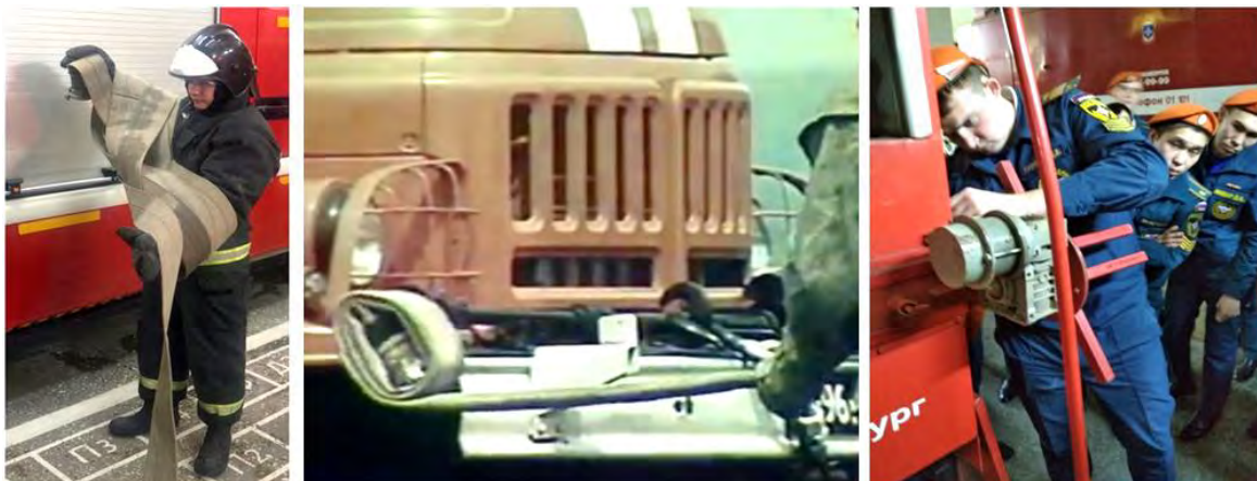
Рисунок 1 – Скатка (смотка) рукавов (фото слева на право): ручным способом, так называемая «восьмерка»; с помощью рукавного автомобиля АР-2 (ЗИЛ-131); с помощью рукавного автомобиля АР-2 (КАМАЗ-43318)
