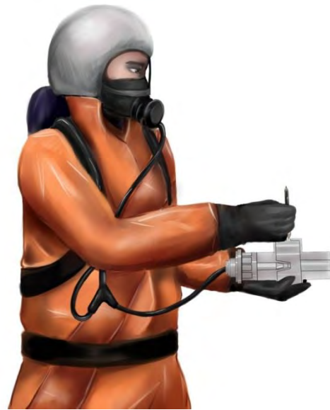
Рис. 1 Индикаторный газоанализатор и способ его применения
