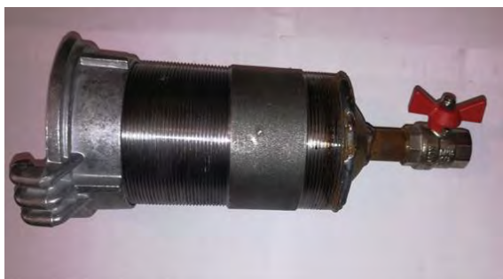
Рисунок 2.1 – Установка шарового крана на левую часть стенда
