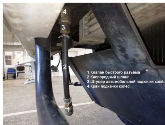
Узел подключения воздушной системы пожарного автомобиля к компрессору
