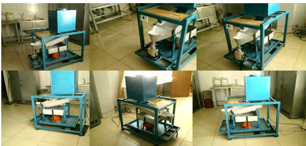
Фото автоматического устройства для просеивания поглотителя химического известкового ХП-И и набивки регенеративных патронов, применяемых в автономных изолирующих дыхательных аппаратах типа Р-30
