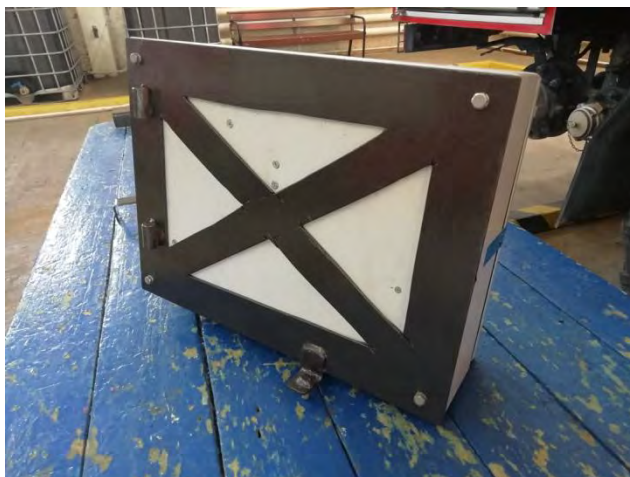
Блок управления крепится четырьмя болтами к поворотной рамке
