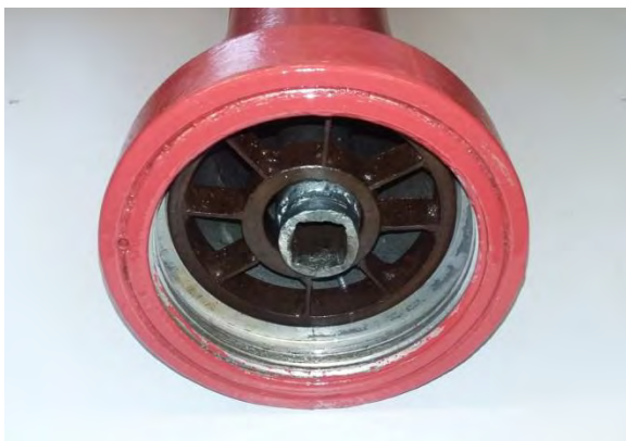
Пожарная колонка в сборе после модернизации
