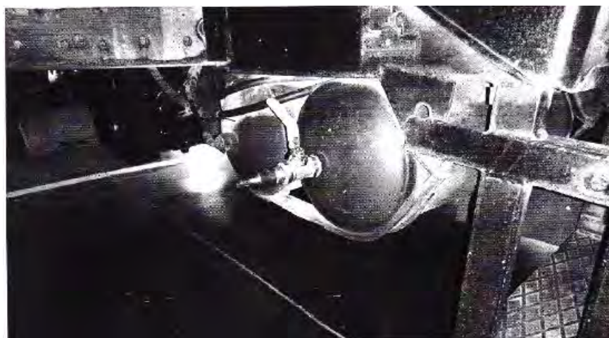
Ресивер автомобиля со штуцером для подсоединения быстроразъемного соединения
