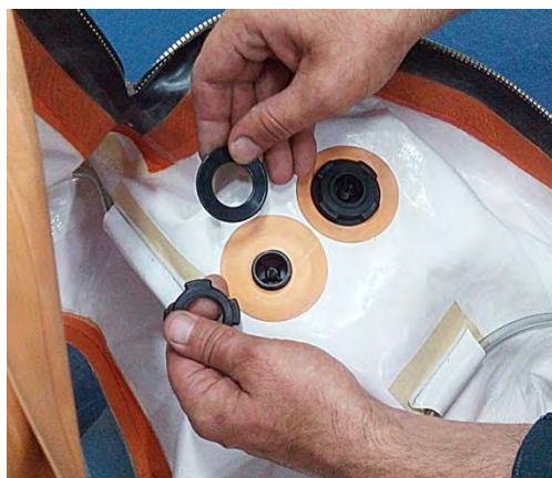
Рис. 10 Демонтаж клапанов избыточного давления
