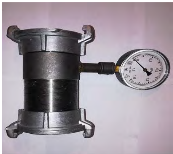
Рисунок 2.2 – Соединение соединительных головок с трубой
